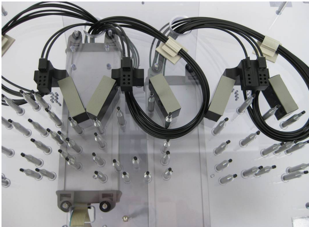
Bild 2: Prüfadapter mit kundenspezifisch gefertigten LWL-Aufnahmen
