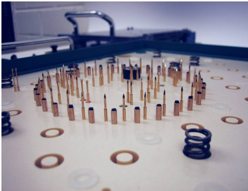
Bild 1: Anordnung von Lichtwellenleiter-Aufnahmhülsen zur Abfrage von LEDs
